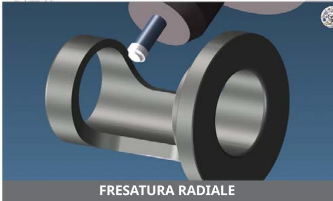
**FRESATURA RADIALE** aziona un asse di rotazione e tre assi lineari per ottenere un percorso utensile a 4 assi. Offre un processo di sgrossatura e finitura per la lavorazione sfrutta l'asse di rotazione della macchina contemporaneamente all'asse Y, consentendo di controllare gli angoli di parete e l'entrata dell'utensile. L'input è una geometria wireframe 3D estratta da solidi o creata mediante altri mezzi, per azionare e orientare l'utensile.
