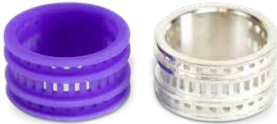
采用 VisiJet M2 CAST 打印的指环和银质铸件
