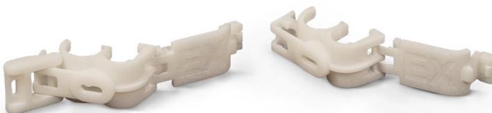
注記のあるものを除き、上記データ生成に使用されたパーツは 80% の未使用粉末を使用して ProX<sup>®</sup> SLS 6100 プリンターでデフォルトパラメータを使用して作成されたパーツ積層により生成されたもの。
