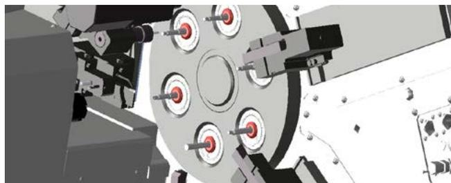
此类机床的目的是消除刀具更换需求，并最大程度减少 X 和 Y 轴运动。各个主轴都有自己的棒料供给器，棒料供给器通过筒夹或导套将材料拉出。每个刀座上完成有限操作，然后筒旋转使零件移动至下一刀具组（分度至下一工位），直到零件加工完成、切断并在第 6 个刀座落下为止
