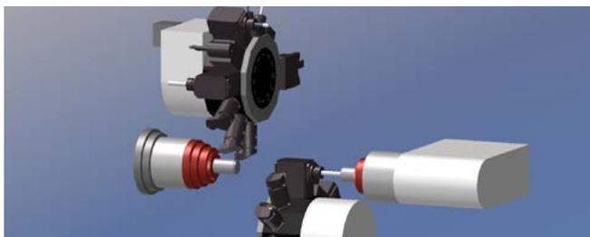
**双转塔，双主轴：**这种机床通常配置上下转塔，可以实现同步车削，因此能够将粗加工时间缩至一半。此类机床最多可以 8 轴联动：X、Y、Z 轴在上转塔上运动，X 和 Z 轴在下转塔上运动，另有 Z（或 A 或 W）轴在副主轴上传送零件，C 轴则在每个主轴上做旋转运动。
