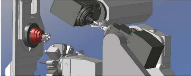
**B 轴机床：**任何机床都可以有 B 轴，从而能够加工倾斜平面，或以不平行于或垂直于零件中心线的倾斜角钻孔和攻丝。至少有一个转塔被替换为带有刀具座、B 轴和刀具库的旋转铣削主轴。最低限度下，双主轴机床具有一个 B 轴刀具主轴，而非转塔。可以通过增加一个或两个转塔来提升配置。
