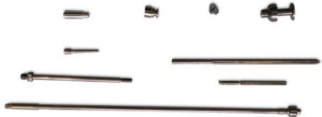
例如，采用 8 毫米坯料加工的手表零件。
