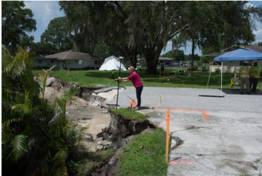
Lori Collins 博士使用 GPR 探地雷达技术收集有关天坑的地下数据
