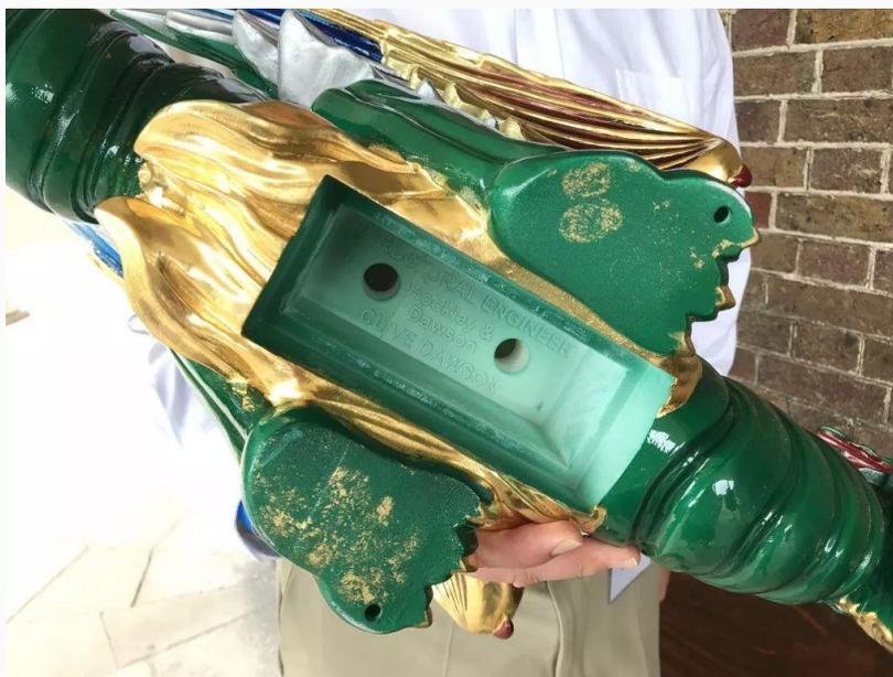
除了轻量化之外，3D 打印还确保每条龙都能保留一些个性。总的来说，主龙设计上有 18 个 3D 打印版本，图中的左右镜像保留了格鲁吉亚的对称性。
