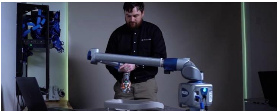
使用 FARO 扫描仪采集显示器外壳数据
