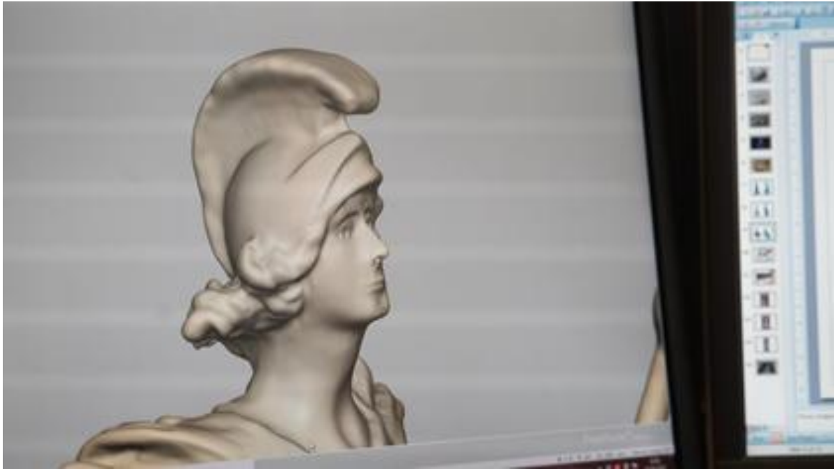
扫描数据在进行 3D 打印和铸造流程之前用 Geomagic Freeform® 修复和完善
