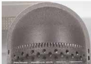
在不使用支撑物的情况下,可打印直径为 15 毫米的圆顶
